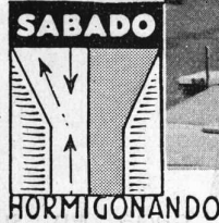
Las flechas en el gráfico, indican por donde se efectuaba el tránsito y la parte grisada señala la sección en construcción.
