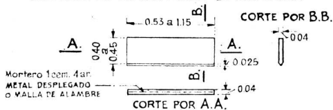
DETALLES DE LA LOSA PARA EL DIAFRAGMA
