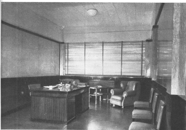
Despacho del Presidente del Directorio, revestido de finas chapas de abedul floreado y palisandro. El piso es de "hardboard" y el cielo raso construido con material acústico. Los muebles son de palisandro.
