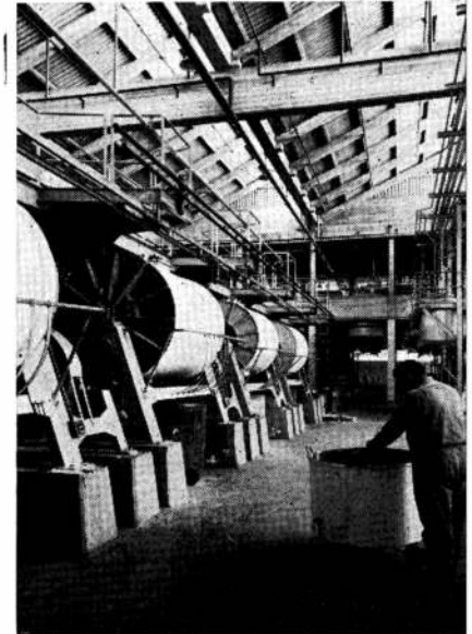
Vista interior del edificio Fábrica, en primer plano a la izquierda sector molienda en molinos a bolas, al fondo el sector de dilución y envasamiento.
