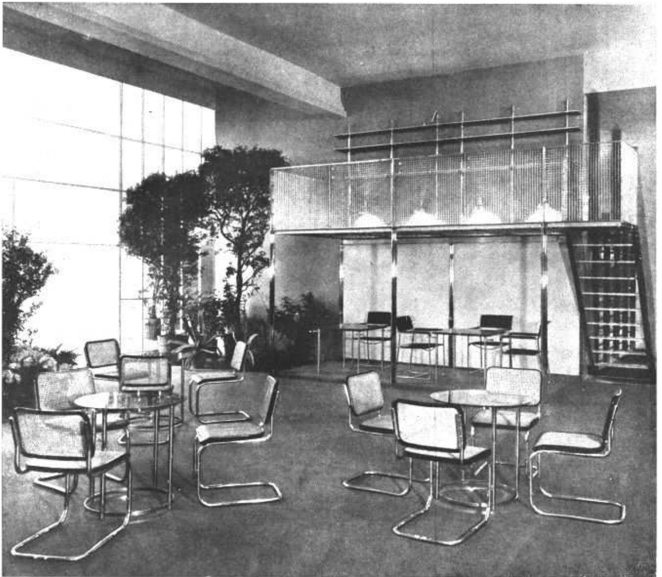
Sala de lectura. Las mesas, sillas y la estantería para libros están construidas con caños de acero cromado. La galería y las ventanas son de metal blanco.
