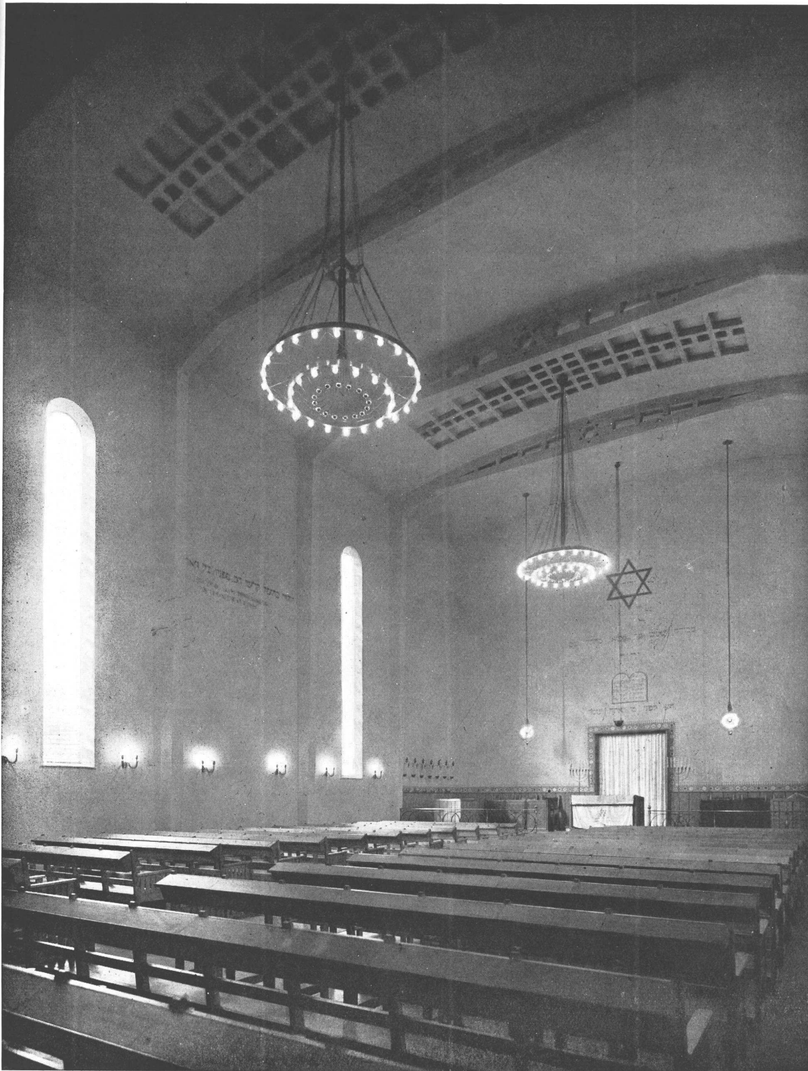
ARQ. ALFREDO JOSELEVICH. Sinagoga en Belgrano. Vista de la nave; el revestimiento del altar y los bancos son de roble; los artefactos eléctricos, candelabros y lámparas de aceite, de bronce; los vitrales de cul-de-vas. Las dimensiones de la nave son ; 12 por 30 y 11 metros de altura.
