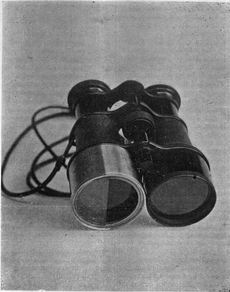
Fig. 2. - Anteojo con el prisma colocado en posición para medir distancias.
