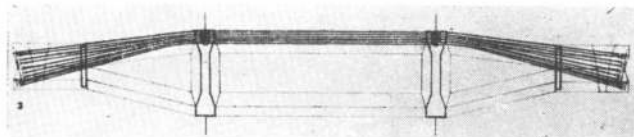
El reforzamiento de las principales vigas-travesaño. 1. — La porción final de las vigas, mostrando la posición de los cables. 2. — Vista superior, mostrando la posición de la terminación de los cables. 3. — Posición de los cables pretensados de 140' en las vigas-travesaño principales.
