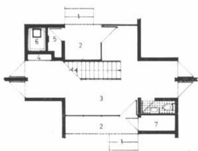
Núcleo de circulación vertical. Planta baja tipo "C". Escala 1:200. 1, vereda. 2, entrada. 3, hall de entrada. 4, medidores eléctricos. 5, antecámara. 6, horno incinerador. 7, medidor de gas.
