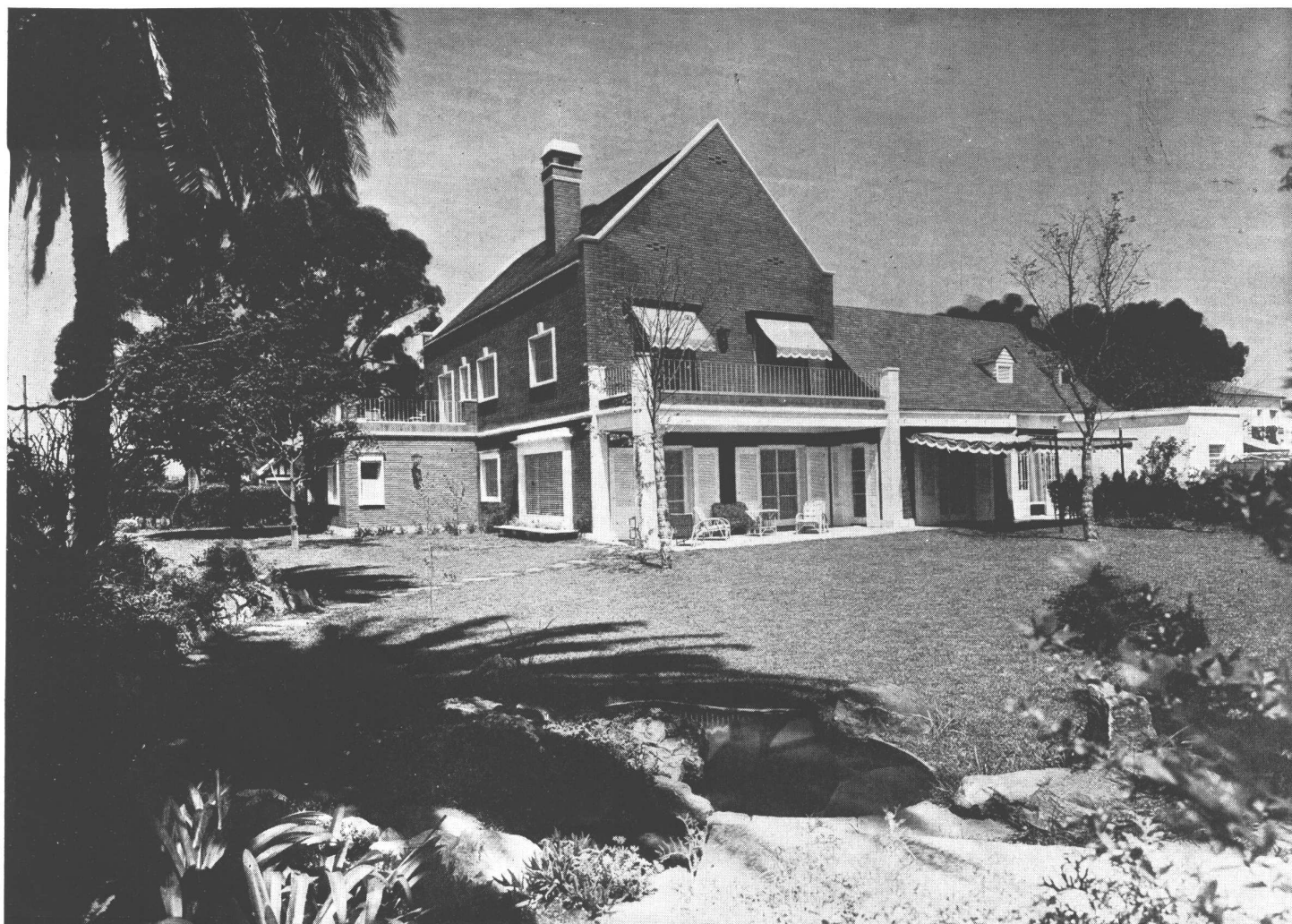
Una vista del frente sobre el jardín de la casa situada en la esquina de las calles Sarmiento y Estrada. Revestimiento de ladrillos cerámicos con junta tomada oscura. Cornisas y contramarcos moldurados color marfil claro, peinado fino. El techo es de tejas normandas "Llao Llao".
