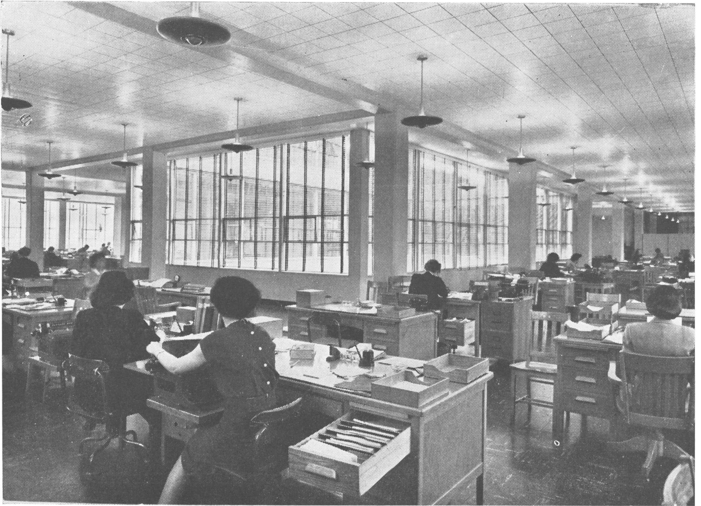
El patio interior ayuda a iluminar las oficinas, que están proyectadas tomando un mueble escritorio standard como módulo.
