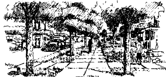
Fig. 5. — Calle residencial. Calzadas angostas sin cordones. Árboles en enfilada o no sobre la vereda más asoleada. Retiro de edificación sin cercas (sombra, variedad, economía).
