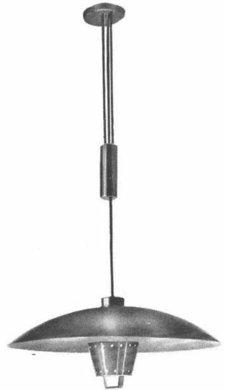
Artefacto de colgar que pende de un sistema de poleas que permiten regular la altura de la pantalla. Da luz por reflexión y la cavidad que aloja a la bombilla tiene unas pocas perforaciones. Ledling.
