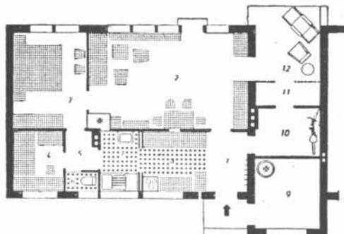
Vivienda para 3 camas, con superficie útil de 60 metros cuadrados. Arq. Wedepohl, Berlín (Introduciendo algunas variantes en la disposición y destino de los cuartos marcados como 9, 10, 11 y 12, se puede, en caso extremo, instalar hasta 6 camas).
