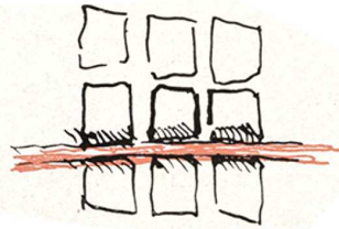
Fig. 37: Se ensancha una calle existente. La operación implica la demolición de las fachadas de los inmuebles a derecha e izquierda. Solución adoptada a menudo.
