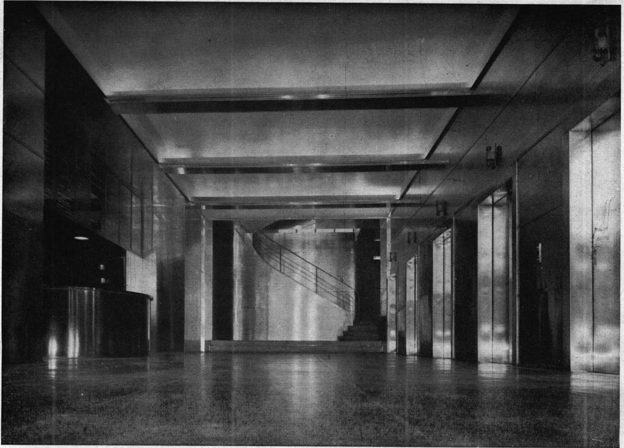
Hall de entrada. - Paredes revestidas de acero inoxidable; piso de goma roja; luz difusa.
