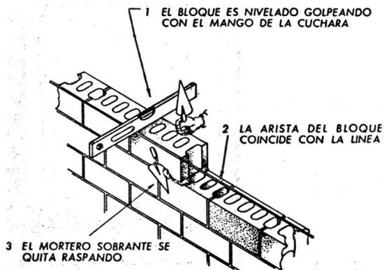
1 EL BLOQUE ES NIVELADO GOLPEANDO CON EL MANGO DE LA CUCHARA
