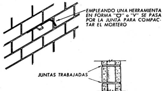
EMPLEANDO UNA HERRAMIENTA EN FORMA "U" o "V" SE PASA POR LA JUNTA PARA COMPACTAR EL MORTERO
