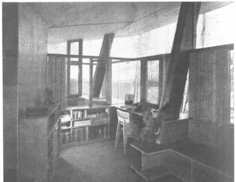
Un aspecto del escritorio colocado en el piso superior, encima del living. Hacia el frente tiene paredes enteramente de vidrio en razón de que lo bordean hermosas vistas. Hacia el rincón donde llega la escalera está separado también con vidrio para evitar los ruidos que podrían subir del living.
