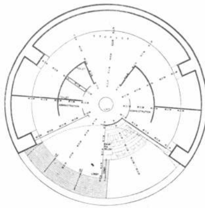
Tres niveles restantes del estadio La Niña. Izquierda: baños para espectadores de ambos sexos, vinculados por dos escaleras al lugar de paseos del nivel superior. Centro: subsuelo destinado a administración y depósito. La administración recibe luz desde el exterior. Derecha: sala de máquinas. Los conductos de aire caliente llegan al sector de esfera a través de los cuatro soportes metálicos.
