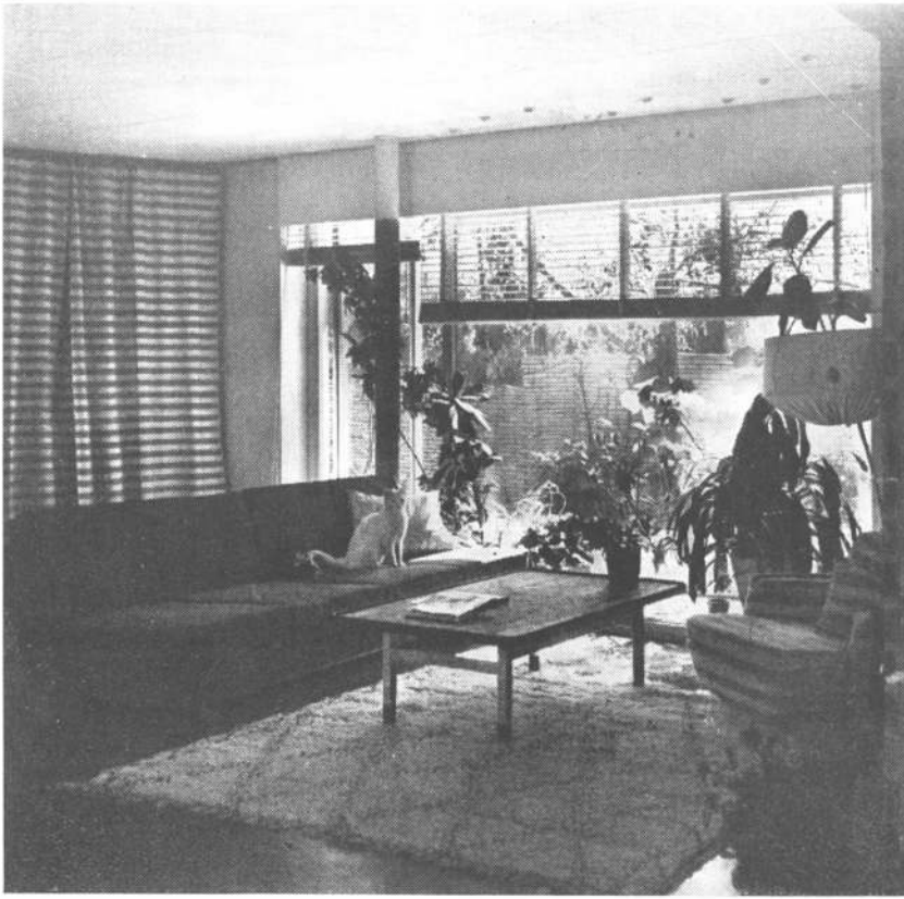
Vista del living room mostrando uno de los grandes ventanales con que se ha provisto a la casa. Los vidrios son dobles y fijos y se ha ensayado un sistema de ventilación nuevo para Finlandia.
