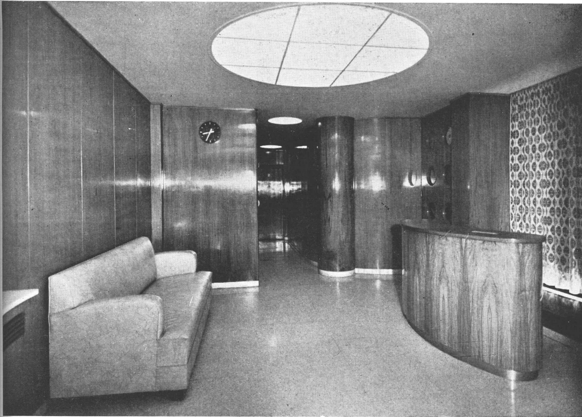
Detalle de la decoración del hall principal; revestimiento de las paredes de nogal lustrado, mostrador de la misma madera, con tapa de linóleo y zócalo de inocon; gran sofá de cuero marfil, cortina de voile. Piso de mosaico Botticino lustrado a plomo.
