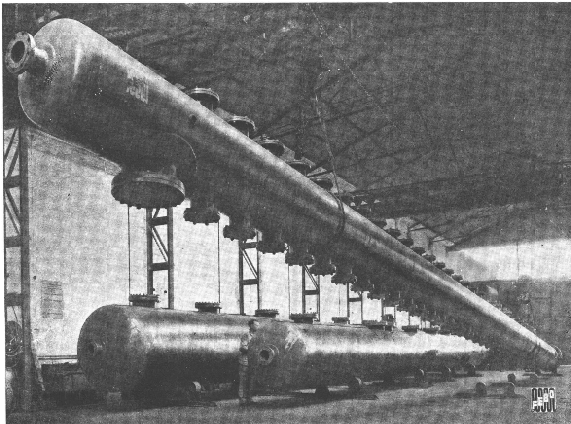
Tres torres para destilación de petróleo, ejecutadas para Y. P. F. Altura máxima 22 m., peso total 48.322 kg. Soldadas eléctricamente. Vista tomada en nuestros Talleres.
