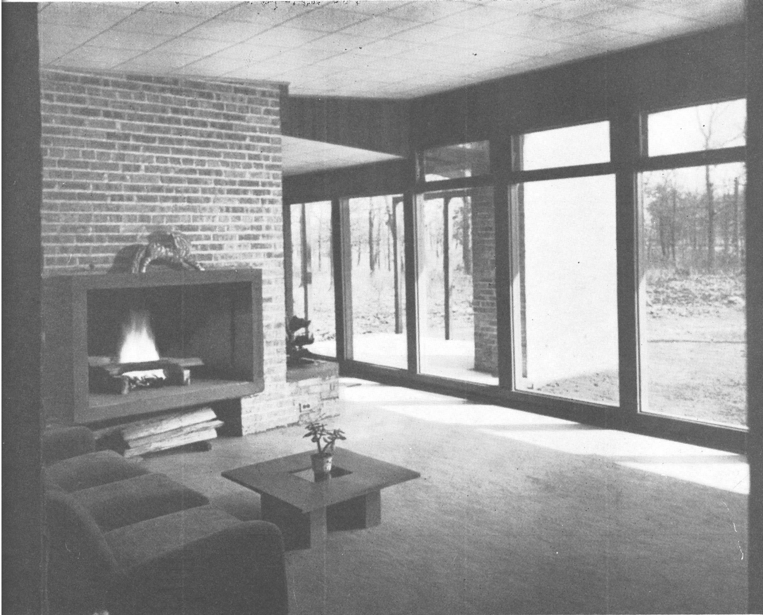
El suelo de la chimenea está levantado respecto al nivel del piso.
