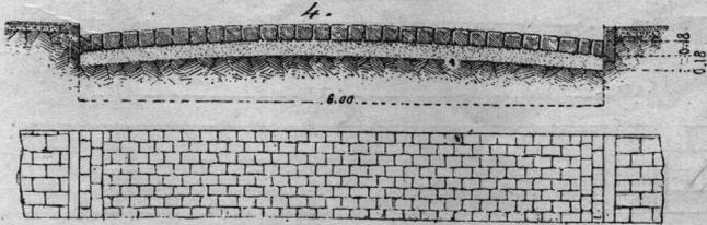
granito con base de concreto. Este está formado por una mezcla de  $\frac{2}{3}$  de metro cúbico de piedra quebrada,  $\frac{1}{3}$  parte de arena oriental y doscientos kilos de cemento portland. Las mismas proporciones empleó la compañía franco-argentina de afirmados de madera en las 70 cuadras que construyó. Son las que con poca diferencia se emplean en otras ciudades para formar la base de los afirmados de granito, madera ó asfalto.
