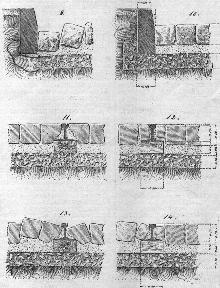
ben asentarse sobre una superficie perfectamente lisa, se cubría el concreto con lo que aquí llamamos la *chapa*, y que es una capa de espesor de mortero formado por una parte de portland y tres de arena fina oriental. Después de seca la chapa se colocaban los adoquines tocándose por su cara menor y separadas las filas por espacios de un centímetro que se llenaban con un mortero igual al de la chapa.
