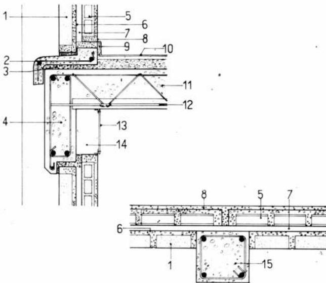
Exterior (muros). Planta prefabricada en planta u obrador de 0,43 x 2,40 m. con terminación exterior incluida (ladrillo a la vista).
