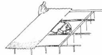
Colocación de la cubierta. Se colocan las viguetas T transversales abulonándolas a los paneles. Se asentarán las chapas fijándolas a los bastidores y a las viguetas con ganchos jota.
